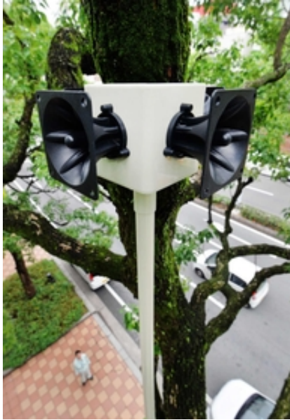
ムクドリ対策で街路樹に設置された音波装置＝姫路市内（撮影・大森 武）
